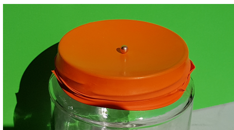
Рис. 15. Из-за разности давлений пленка принимает сферическую форму
