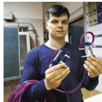
Рис. 3. Трубка заполнена подкрашенной водой, концы зажаты струбцинами
