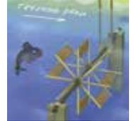
Лопастки будут вращаться по часовой стрелке, поскольку у поверхности реки течение более быстрое, чем у дна, и, значит, давление на верхние лопасти будет больше, чем на нижние.
