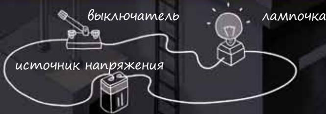
Схема обычной проводки с лампочкой и одним выключателем. Когда выключатель замыкает цепь, по ней начинает бежать ток, а лампочка – светиться.
