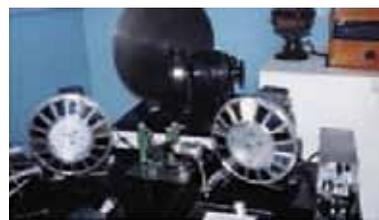
«Механическая телевизион- ная система» – дипломная работа Льва Термена в институте Иоффе. 1925 г.
