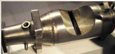
Каталитический конвертер в разрезе. Видна густота пористой структуры.
